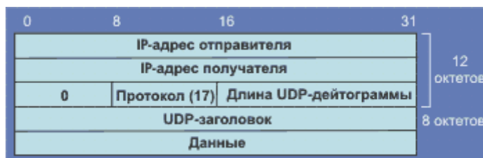
Псевдозаголовок, используемый при расчете контрольной суммы
